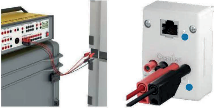
3.1 Test ekipmanı, çap 4mm test fişleri ile donatılmıştır.
